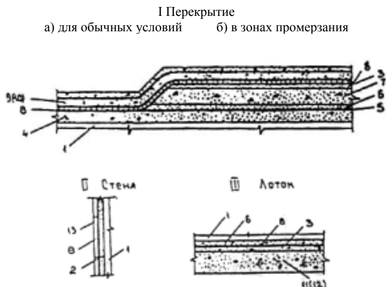
Рис. 2. Конструкция гидроизоляции тоннелей:
