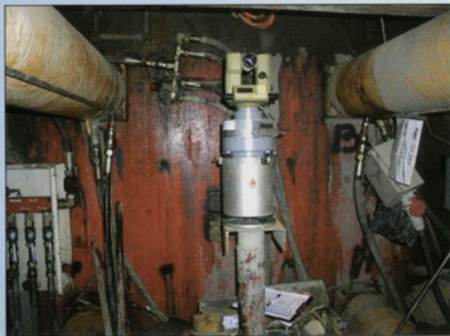
Рис. 2. Прецизионный гироскоп GYROMAT 2000 фирмы DMT в стартовой шахте
