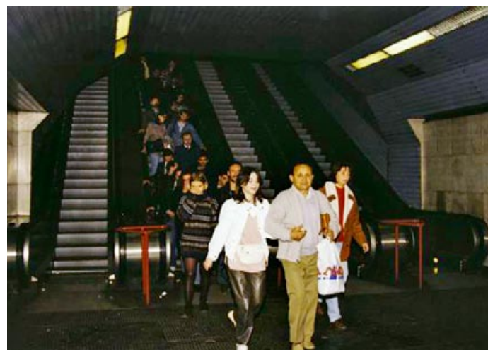
Рис. 2. Будапештский метрополитен. Четыре эскалатора O&K в тоннеле диаметром 7,5 м. В таких тоннелях помещаются только три наши эскалатора (как старых типов — Н, ЭМ, ЛТ, ЭТ, — так и выпускаемых в настоящее время)
