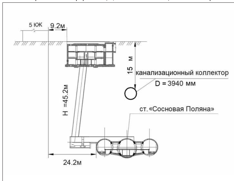
Рис. 3. Взаиморасположение в профиле станции, вестибюля и канализационного коллектора
