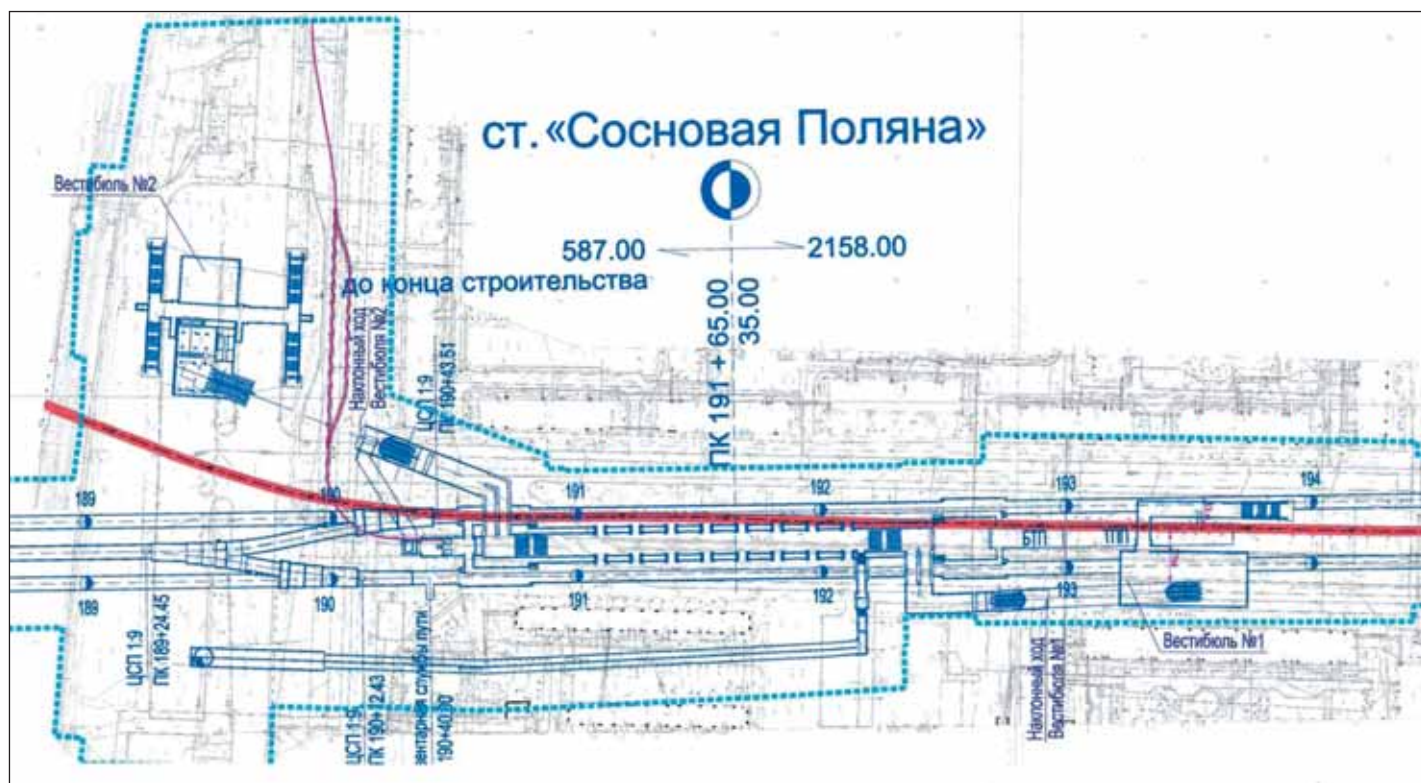
Рис. 2. План размещения вдоль ул. Пограничника Гарькавого станции и вестибюлей «Сосновая Поляна» (красным цветом обозначена трасса канализационного коллектора)
