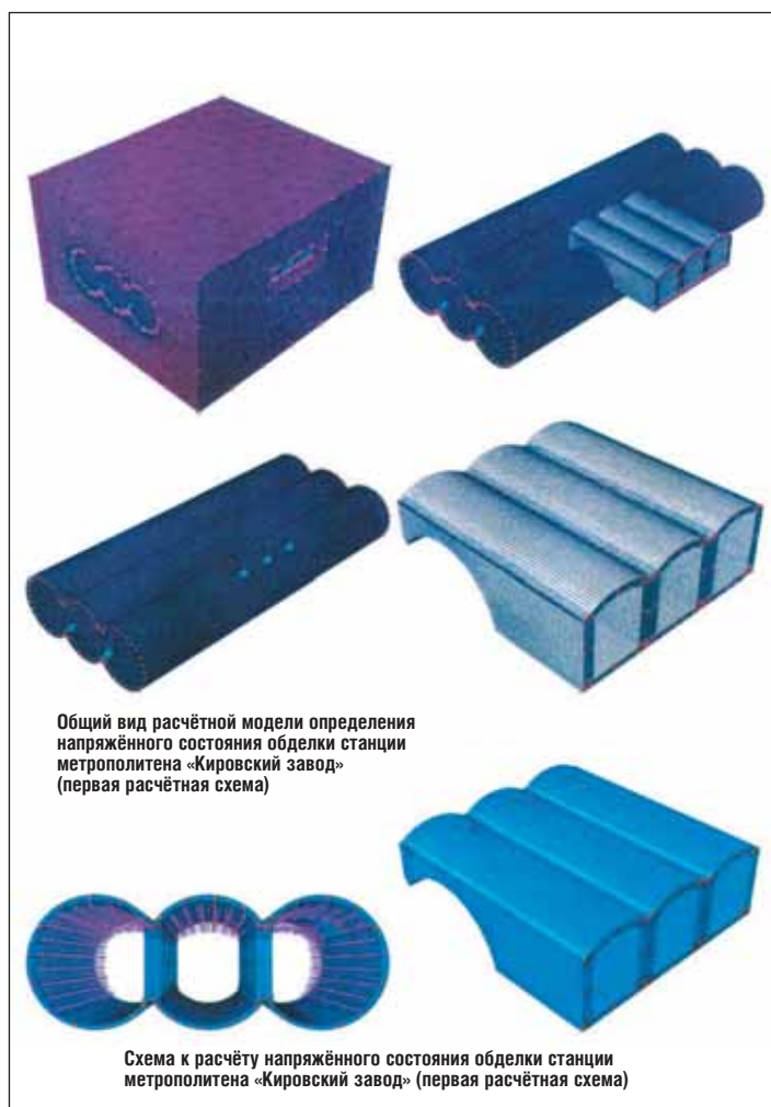
Рис. 7. Первая расчетная схема и общий вид расчетной модели определения НДС станции
